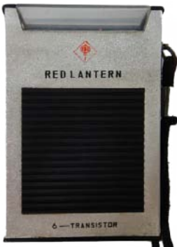
Early 1980s 红灯牌 748 型收音机 上海无线电二厂于 80 年代初生产，6 晶体管 1 波段收音机。
