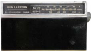
Late 1970s 红灯牌 605-2 型收音机 上海无线电二厂于 20 世纪 70 年代末生产，6 晶体管 3 波段收音机。
