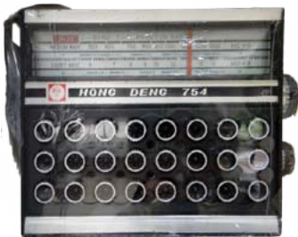
Mid 1980s 红灯牌 754 型收音机 红灯 754 系当年上海无线电二厂的普及型机种，于 80 年代中期生产，是 7 管两波段的便携式机器。
