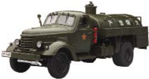
改装车型：由 CA10B 底盘改装的油罐车
